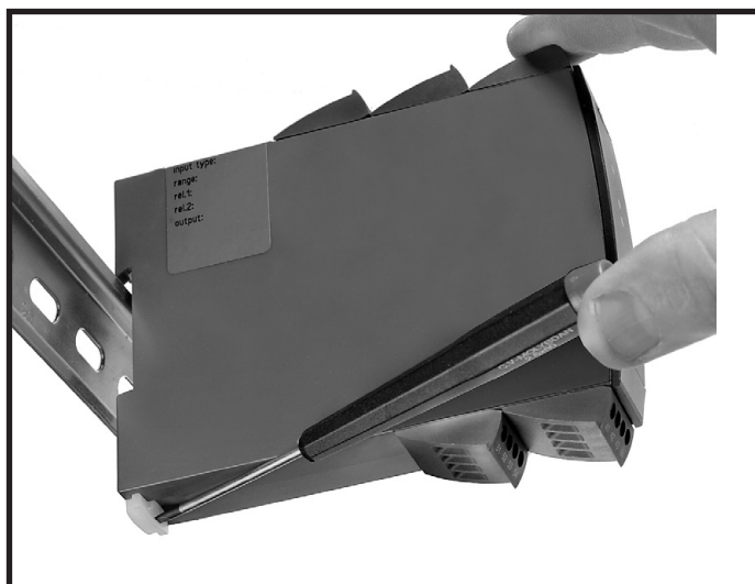
Figura 1: Staccare il modulo dal binario din sollevando la leva di bloccaggio.
